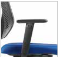
2F-Armlehnen, Auflagen PU soft, höhen- (10 cm) und breitenverstellbar (5 cm); Armlehnen-träger Kunststoff schwarz, Hülse schwarz 2F armrests, PU soft armpads, height- (10 cm) and width-adjustable (5 cm); black plastic armrest posts, black casing. (A208KGS)
